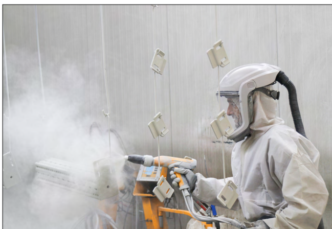
Práškové lakování pomocí stříkácí pistole
