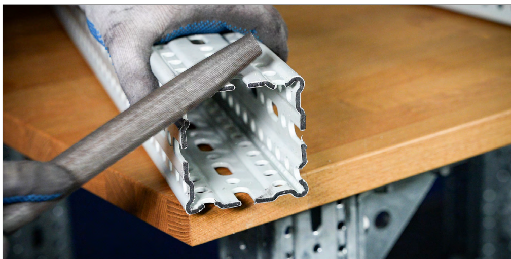
Ošetření řezných hran ručním pilníkem
