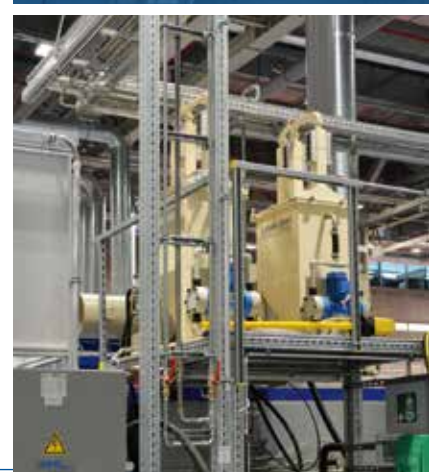
Nosný stojanový rám na média ze systému Framo
