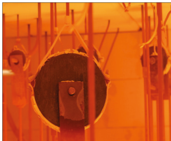
Obrázek 6.2: Požární zkoušky potrubních svorek /Sikla
